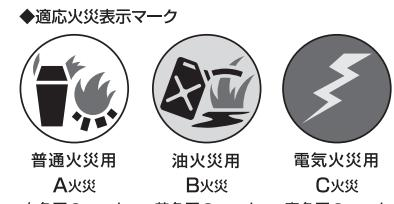
以上の3つの分類に応じて、消火器も適応火災にふさわしい使い分けをする必要があります。つまり、防火対象物によって適応する消火器を選んで設置することが必要です。消火器の銘板には適応火災を示すマークが明示されています。
