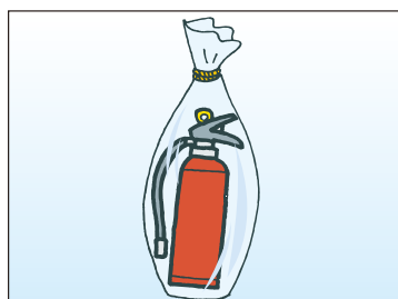
正しくない固定方法 ストッパーが固定されていない
