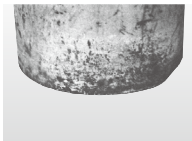
・紙やヤスリでサビを落としても地肌に腐食が残るもの
