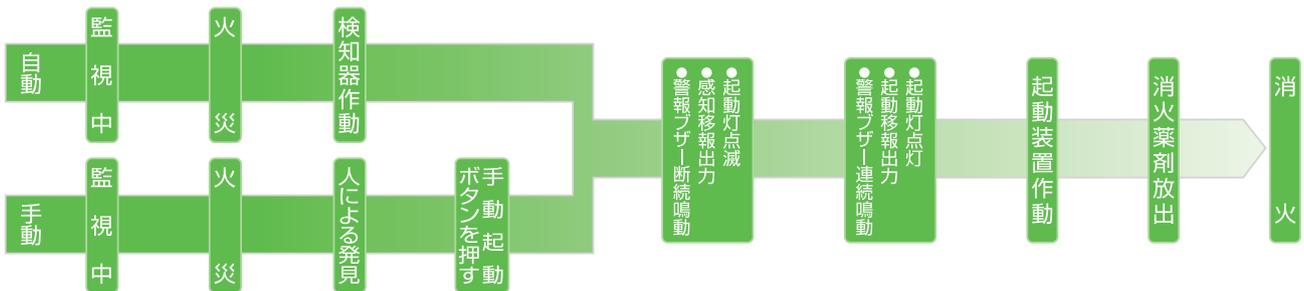
**高機能型** ※高機能型とは汎用型に機能を追加しているもので、より素早く正確に火災を検知し、確実な消火に繋がるよう、温度・煙・光(炎)等複数の要素を同時に検知できる機能を確保しております。
