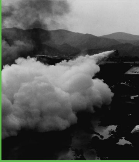
粉末消火設備は消火粉末を火源に大量放射することで、燃焼面を覆い空気遮断による窒息効果、粉末消火剤が熱により分解し、発生する炭酸ガスによって空気中の酸素濃度を下げる希釈窒息効果、化学作用によって燃焼の連鎖反応を中断する負触媒効果(抑制効果)の相乗効果により、即効的に消火できます。
