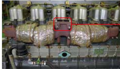
過給機を取り外し、排気管内部の未燃燃料や燃焼残渣物の異常な堆積有無を目視点検
