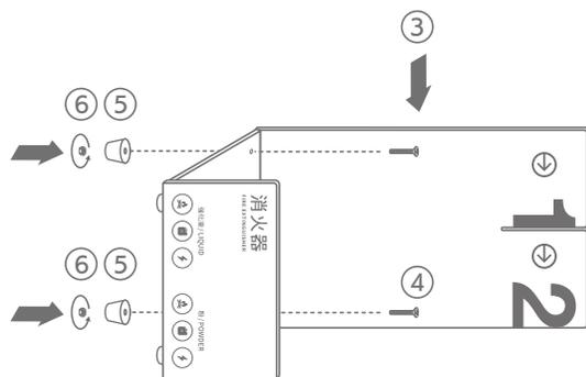
**4** ③を上図のように設置し、ステップ2と同様に④を通します。
