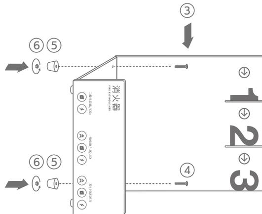
**4** ③を上図のように設置し、ステップ2と同様に④を通します。
