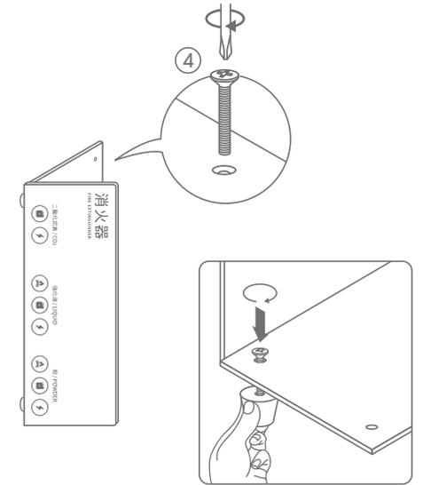
**3** 指で⑤を少し引っ張り、脚内部の⑥を固定した状態で、スクロードドライバーを使い④を時計回りに締め込みます。
