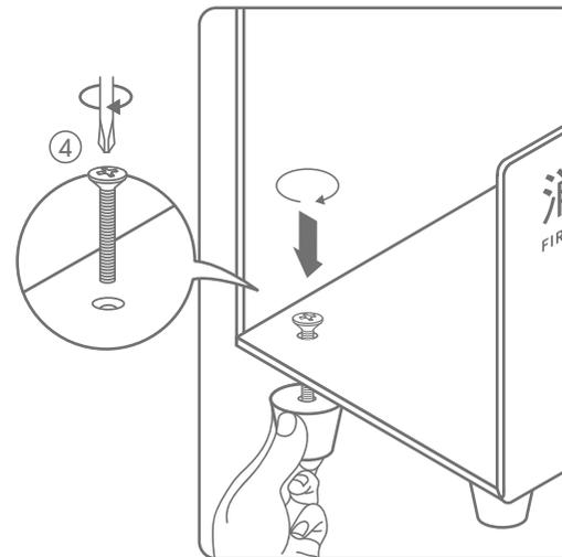
**5** ステップ3と同様に、指で⑤を少し引っ張り、脚内部の⑥を固定した状態で、スクロードドライバーを使い④を時計回りに締め込みます。
