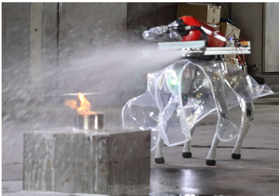
消火活動を行う四足ロボット
