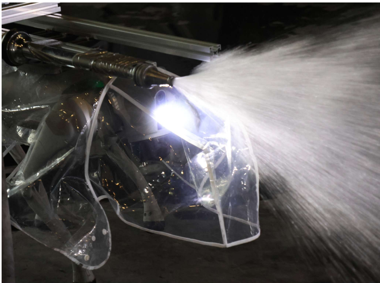
消火活動を行う四足ロボット
