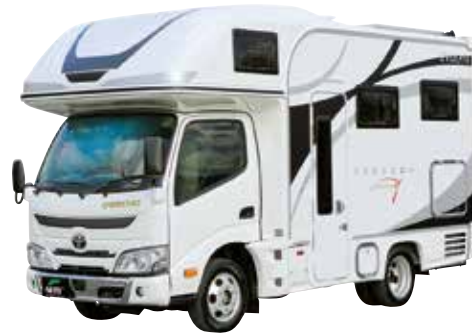
写真提供：株式会社ナッツ トラックをベースとしたキャンピングカー「キャブコン」タイプ。
