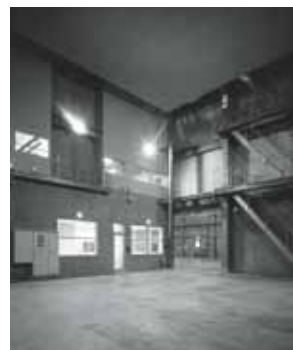
15m×15m×15m[H] (225m 2 3,375m 3 ) 放水能力：1,000L/min(8.83MPa)
