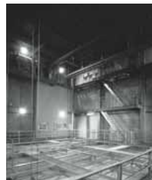
15m×15m×15m[H] (225m 2 3,375m 3 ) 放水能力：1,000L/min(8.83MPa)
