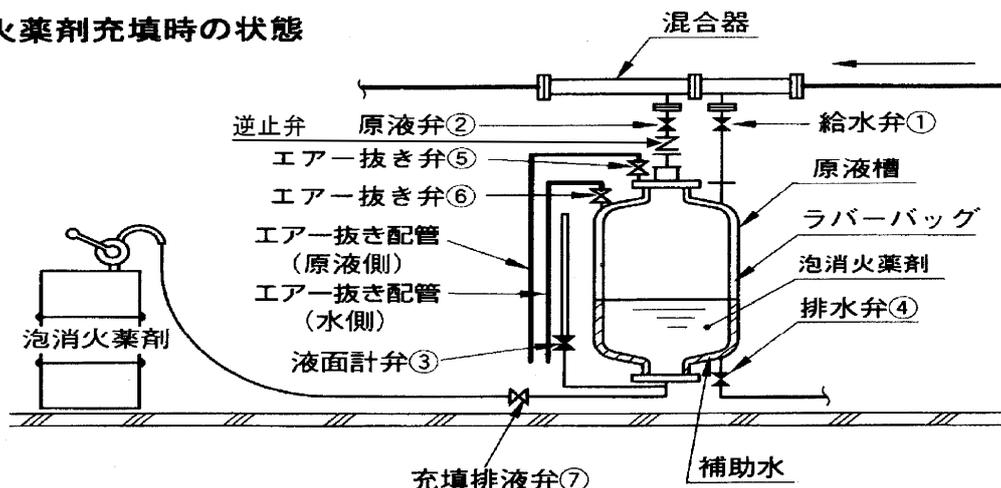
ニ) 排水弁④を閉じ、充填排液弁⑦から規定量の泡消火薬剤をギヤーポンプ等で充填を行う。
