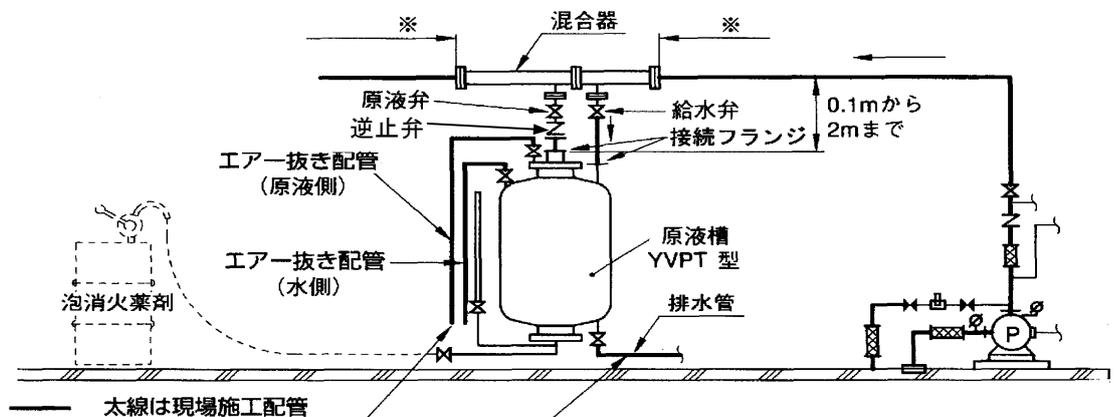
エア-抜き配管は、原液槽 下部まで、延長配管してください。（原液槽に飛散しない方法を講ずればよい）
