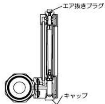
※ 凍結により、流量計のガラス管が破損する恐れがあります。流量計を使用した後は、必ず水抜きを行ってください。
