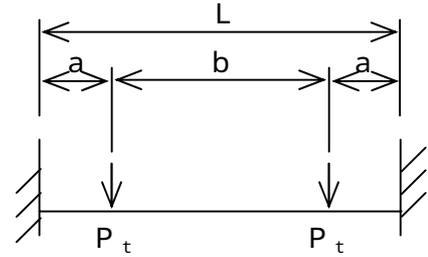
以上より、最大曲げモーメント ( Mmax ) は両端に働くため、
