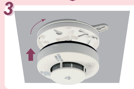
3: 本体を互換ベースにあわせ、時計回りに回して固定してください。
