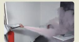
粉末薬剤が部屋中に付着し、お掃除が大変。電子機器などが故障する恐れあり。
