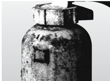
・あばた状の腐食
