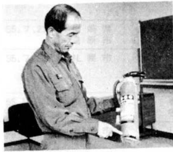
底がぼろぼろになった消火器、常に細かい点検を！加世田消防署で
